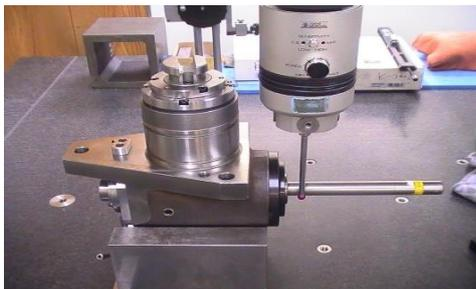
三次元測定機による静的試験
